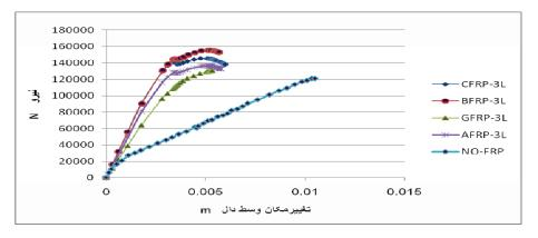
شکل ۱۰- مقایسه نمودار نیرو – تغییر مکان دال بتنی تقویت شده با انواع FRP (سه لایه) طبق الگوی نوع ب
