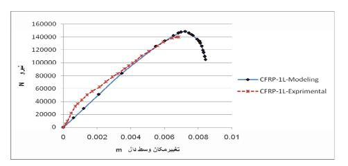
شکل ۳- مقایسه بین نتایج آزمایش و تحلیل
