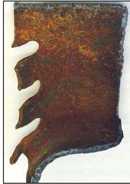
شکل ۱۱- نحوه پارگی جان تیر در محل سوراخ پیچ ها
