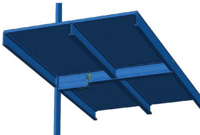
شکل ۷- مدل اجزاء محدود قاب‌های داخلی در طبقه ۸ (محل تخریب اولیه)
