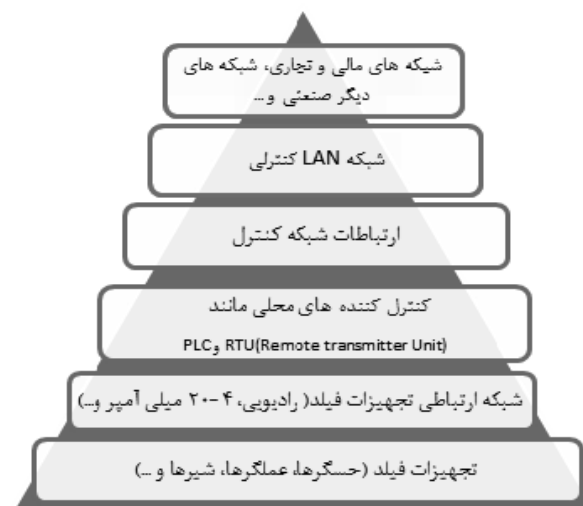
شکل ۱- لایه های یک شبکه کنترل صنعتی
