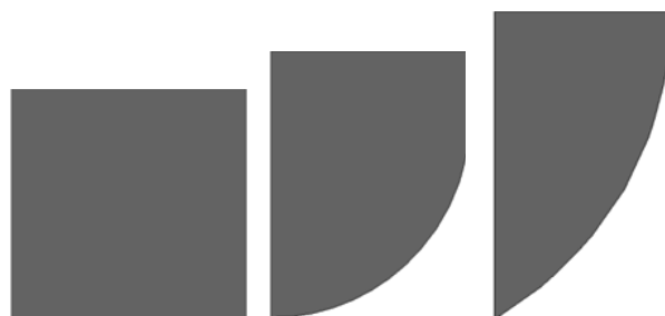
شکل ۴- پرتابه‌های فلزی به صورت تقارن محوری با سر نفوذگر به ترتیب از راست به چپ به شکل: اجایو، نیم‌کروی و تخت
