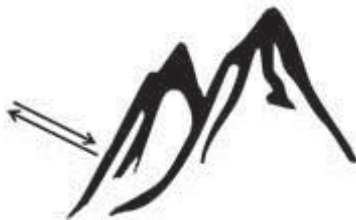
شکل ۷- بازتاب قوی امواج الکترومغناطیس از سطوح صاف
