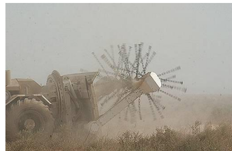
شکل ۱۴- پاک‌سازی به وسیله مین‌کوب
