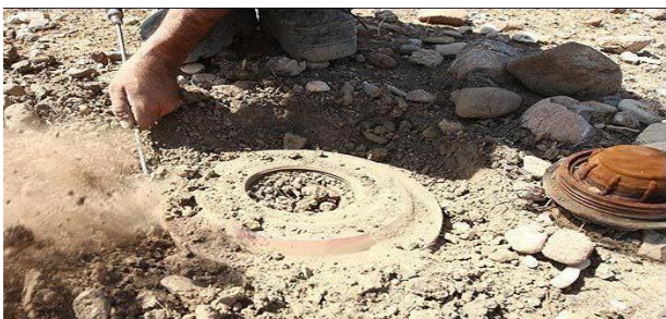
شکل ۱۳- پاک‌سازی به روش سنتی با استفاده از سیخ
