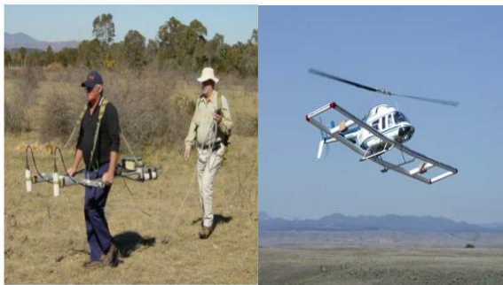
شکل ۳- مغناطیس‌سنج زمینی و هوایی [۴]
