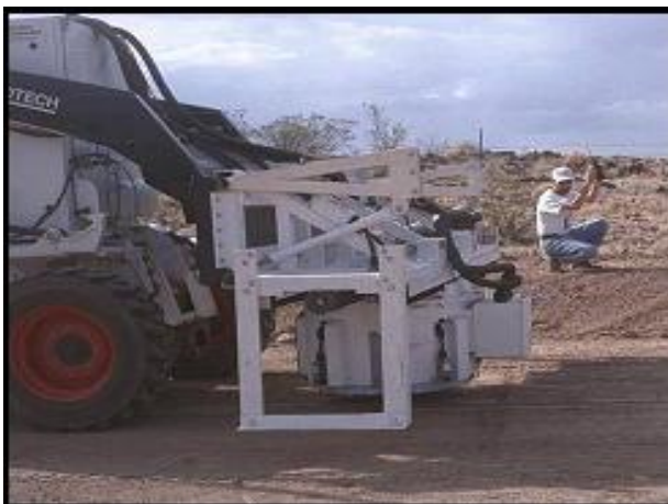
شکل ۱۶- دستگاه نوترونی جهت کشف مین [۱]
