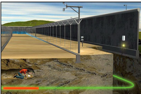
شکل (۱۷): استفاده از حسگر \Phi -OTDR در پایش امنیت مراکز حساس.
