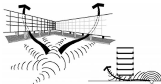
شکل (۳): شکل مناسب نمای ساختمان برای کاهش ریزش آوار به محیط (مبحث بیست یکم مقررات ملی ساختمان).
