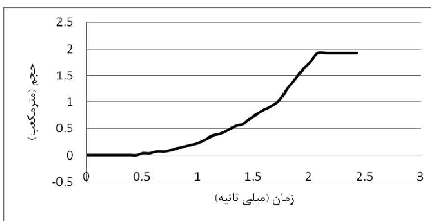
شکل ۸- نمودار حجم سنگ جداشده بر حسب زمان با استفاده از ماده منفجره C4
