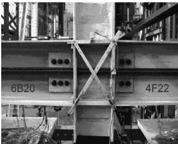
شکل ۳- اتصال پس کشیده با میراگر اصطکاکی جان تیر [۸].
