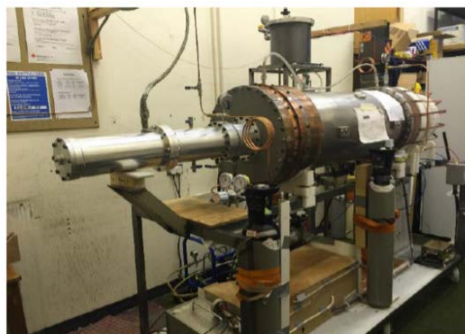
شکل (۴): ژنراتور پالسی مبتنی بر ترانس تسلا [۵]
