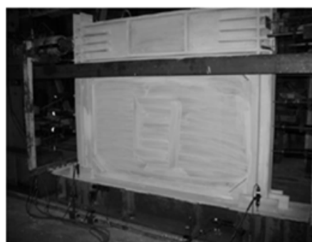
شکل (۲): نمونه آزمایشگاهی دیوار برشی فولادی لاغر بدون سخت کننده صبوری قمی و اسعد سجادی [۲۶]
