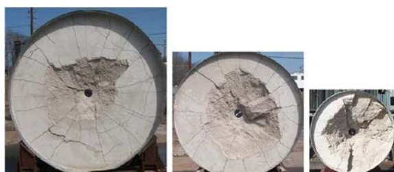
شکل (۶): ناحیه چاله‌ای به وجود آمده در آزمون برخورد [۲۱]
