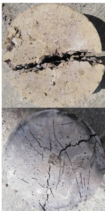
شکل (۳): نمونه‌ها پس از آزمون وزنه افتان
