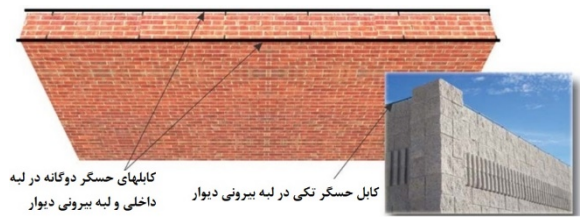
شکل (۱۷): نحوه قرارگیری فیبر نوری روی دیوار [۵]
