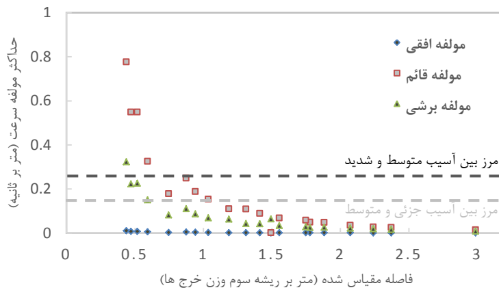
شکل (۹): PPV و مرز خسارت در المان‌های مدل ۱
