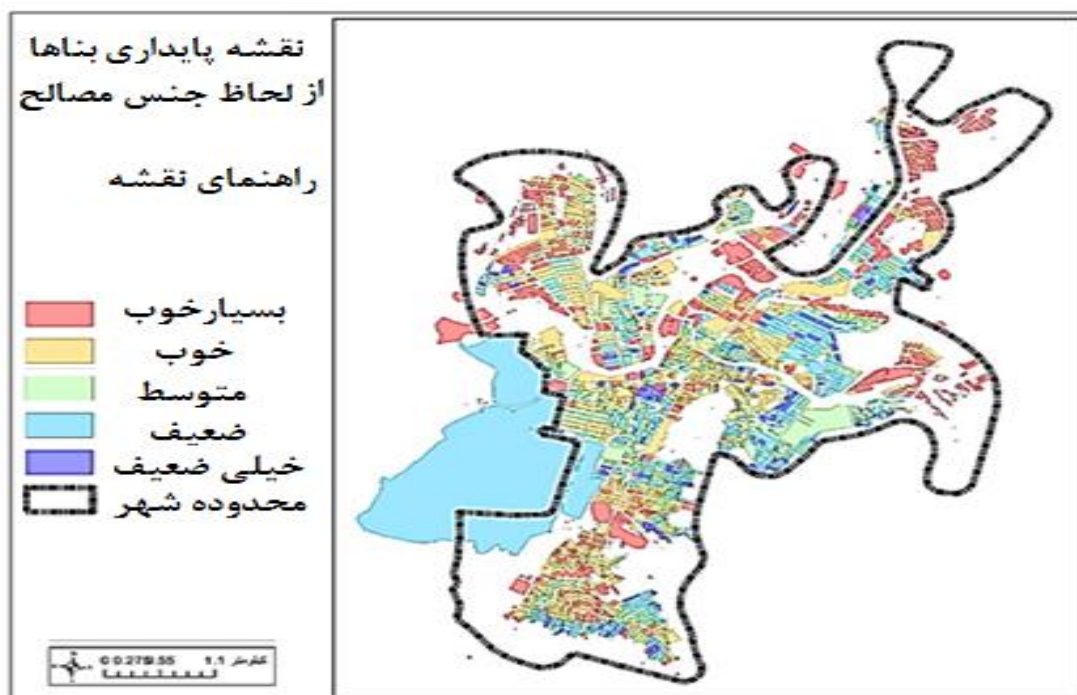
شکل (۸): نقشه شاخص درصد پایداری بناها از لحاظ جنس مصالح در مهاباد
