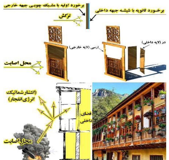
شکل (۱۵): نحوه عملکرد بازشوهای ماسوله در هنگام اصابت و انفجار
