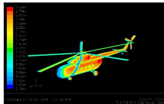
شکل (۱): کانتور سولار فلاسک یا تابش خورشیدی شبیه‌سازی شده در این تحقیق در شرایط مشابه [۷] و با ضریب جذب ۰/۲
