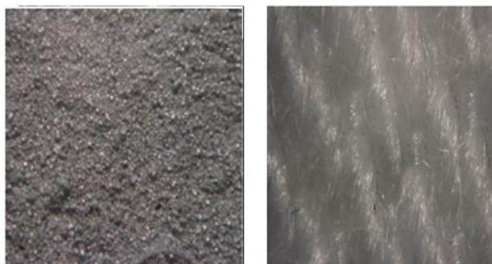
شکل (۳): تصویر میکروسکوپ استریو: نمونه شاهد (سمت راست) و پارچه با پوشش آلومینیوم (سمت چپ)
