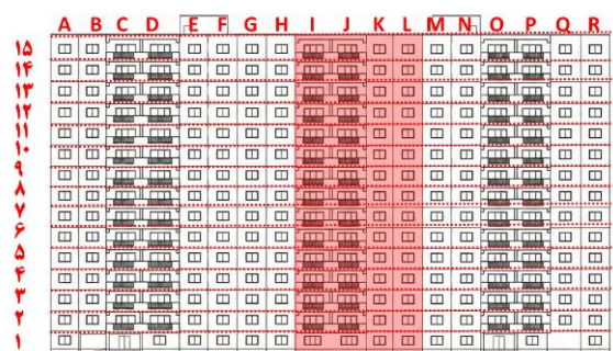
شکل (۱۴): بخش‌های آسیب‌دیده در نمای ساختمان‌های
